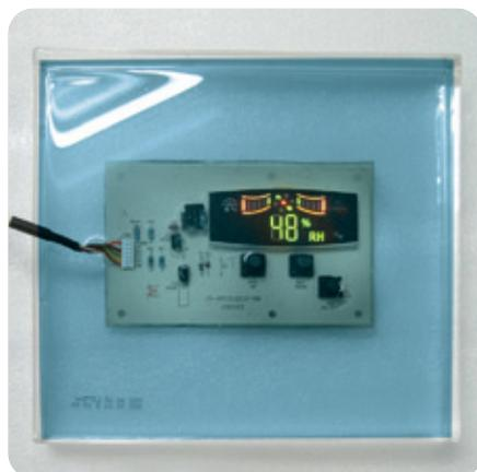
Надёжная защита внешних и внутренних элементов прибора. В осушителе RIVIERA установлен долговечный влагостойкий контроллер со встроенным гигростатом. Эпоксидная смола дает надежную защиту электроники от влаги
