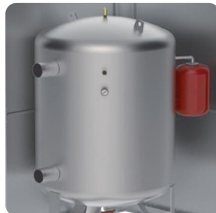
Встроенные в гидромодули аккумулирующие баки емкостью до 2500 л обеспечивают увеличение инертности системы и гарантии соблюдения максимально рекомендованной частоты включения компрессоров чиллера, что значительно повышает надежность всей системы в целом
