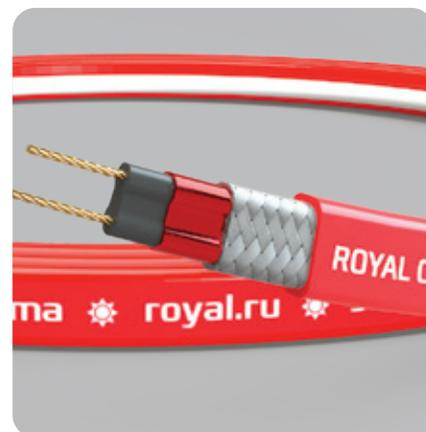
Все нагреватели производятся из саморегулирующегося греющего кабеля с оплеткой из луженой меди и двойной полимерной оболочкой. Функция саморегулирования дает возможность перехлестывать кабель, не образуя зон перегрева
