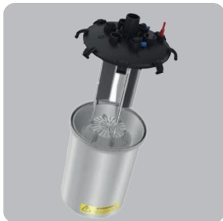
Сменный паровой цилиндр и электроды из нержавеющей стали. Благодаря удобным адаптерам подключения смена цилиндра и электродов проходит за считанные минуты, что сокращает издержки на обслуживание и упрощает работу с оборудованием
