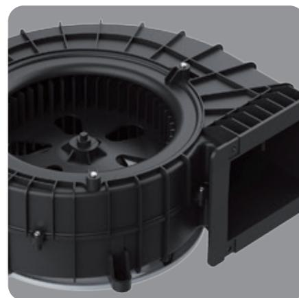
Эффективный вентилятор с загнутыми вперед лопатками оборудован DC-двигателем, который обладает тремя скоростями и позволяет выбрать оптимальное количество воздуха, подаваемого в помещение
