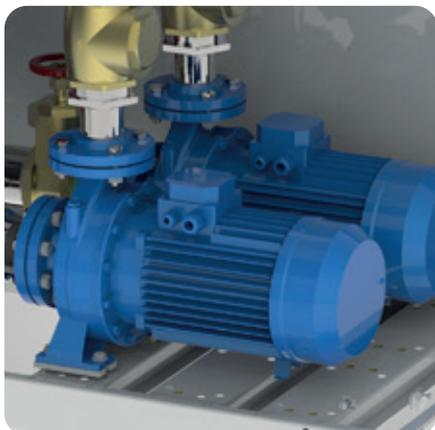
Сдвоенные центробежные насосы работают по схеме «один рабочий + один резервный». Каждый насос оснащен одним рабочим колесом, корпусом из чугуна, электродвигателем в алюминиевом оребренном корпусе с уплотнением из керамики / графита / EPMD (IP55) и с валом двигателя из нержавеющей стали AISI 304
