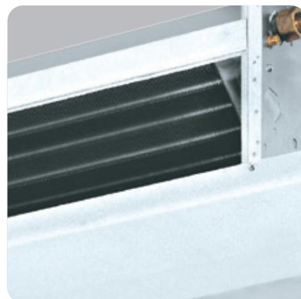
Дренажный поддон изготовлен из оцинкованной стали со слоем теплоизоляции, что предотвращает образование конденсата на его наружной поверхности. Поддон снабжен дренажным патрубком со стороны подключения труб, что облегчает монтаж
