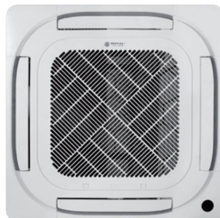
Кассетные полупромышленные блоки имеют функцию кругового (на 360°) распределения воздушного потока — для этого по углам декоративной панели и в самом блоке сделаны дополнительные отверстия, через которых воздух распределяется в дополнение к отверстиям, закрытым жалюзи. Данная функция позволяет более равномерно распределять охлажденный воздух по помещению, повышая комфорт пользователей.
